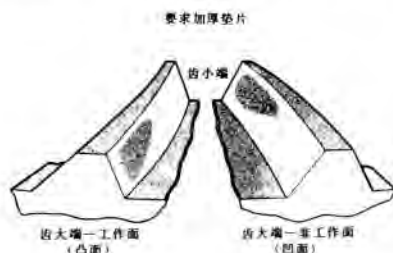
图 12-39 不正确的接触印迹
